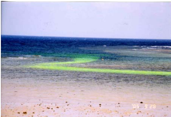
写真-7 観測前に波浪が主因と予想してしまったリーフカレント
