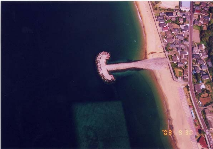
写真-1.3 冲向き流れを生じやすい海岸構造物のある人工海浜
