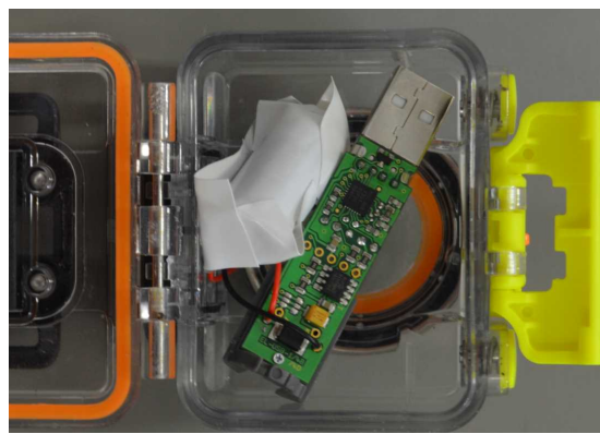
写真-6 防水ケースへの封入状況
